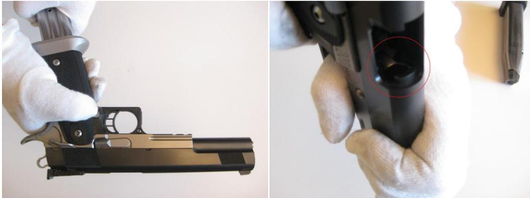
2. Ziehen Sie den Schlitten soweit nach hinten bis die halbmondförmige Schlitten-Aussparung über dem Schlittenfanghebel ist.
