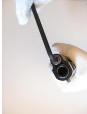
5. Ziehen Sie das vordere Ende der Stange nach vorne aus dem Schlitten. **Achtung: Die Feder steht unter starker Spannung.** Die Feder können Sie nun mit dem hinteren Ende der Stange aus der Hülse herausziehen. Die Federführungshülse können Sie auch nach hinten aus dem Schlitten ziehen.
