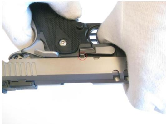
3. Entfernen Sie den Schlittenfanghebel so, dass die Erhöhung des Hebels unter der halbmondförmigen Auskerbung im Schlitten herausgedrückt wird und ziehen Sie den Schlitten nach vorne von dem Griffstück.
