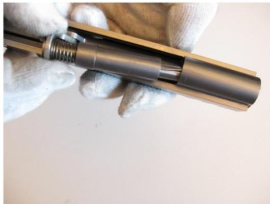
7. Drücken Sie den Lauf leicht aus der Verriegelung und ziehen ihn nach vorne aus dem Schlitten.
