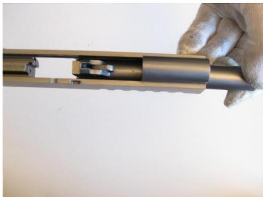
8. Setzen Sie die Waffe in umgekehrter Reihenfolge zusammen. Die Schlittenfederhülse hat hinten einen überstehenden Rand. Drehen Sie die Hülse beim Zusammensetzen so, dass dieser Rand in der vorgesehenen Aussparung im Schlitten sitzt. Die Vorderfläche der Hülse muss bündig mit der Vorderkante des Schlittens sein. **Schießen Sie die Waffe nicht, wenn das nicht der Fall ist!**
